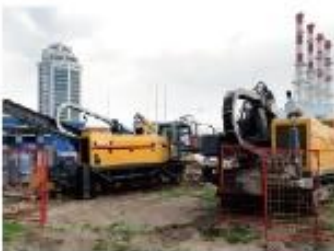
XZ680A水平定向钻机在俄罗斯施工 XZ680A HDD working in Russia
