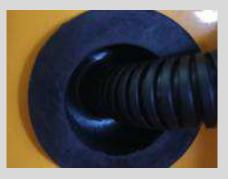
■ 线束及管路护套结构优化,减少 串风
