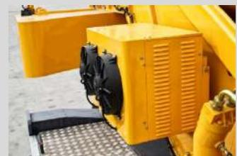
操纵室标配大功率制冷空调，提升空调制冷效果。
